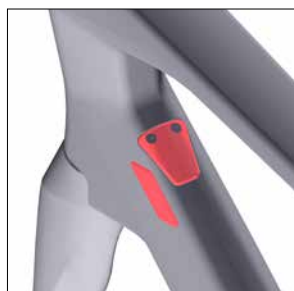
Protection du tube vertical
